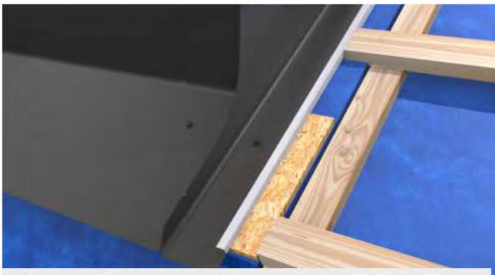
Izolare frontală și laterală, asamblată din partea frontală cu suruburi pe placă OSB.
