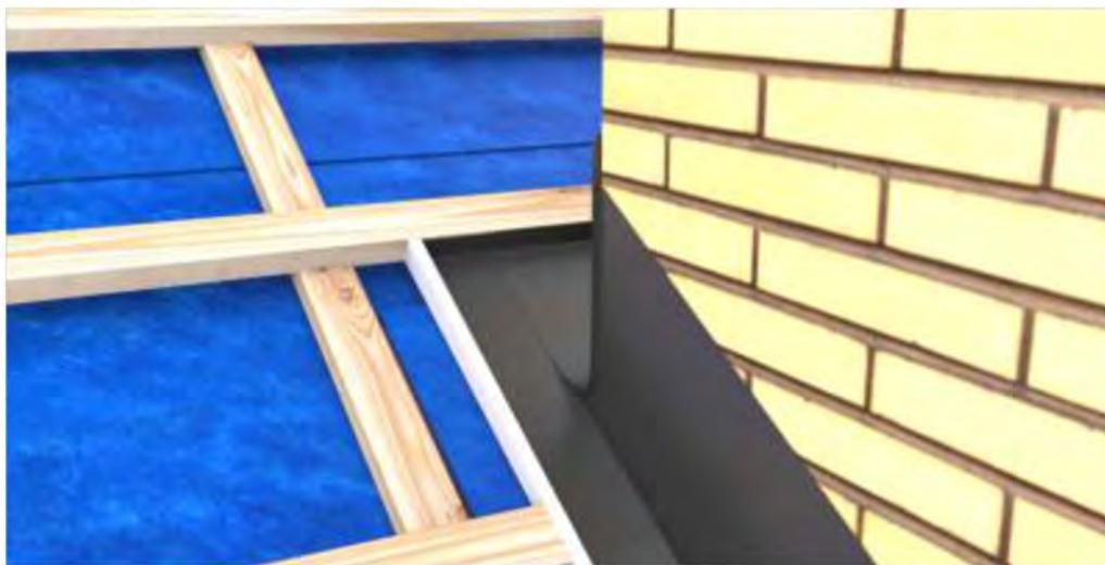
Izolatia inferioara ar trebui profilata prin fixarea in partea superioara a primei sipci, dupa horn.
